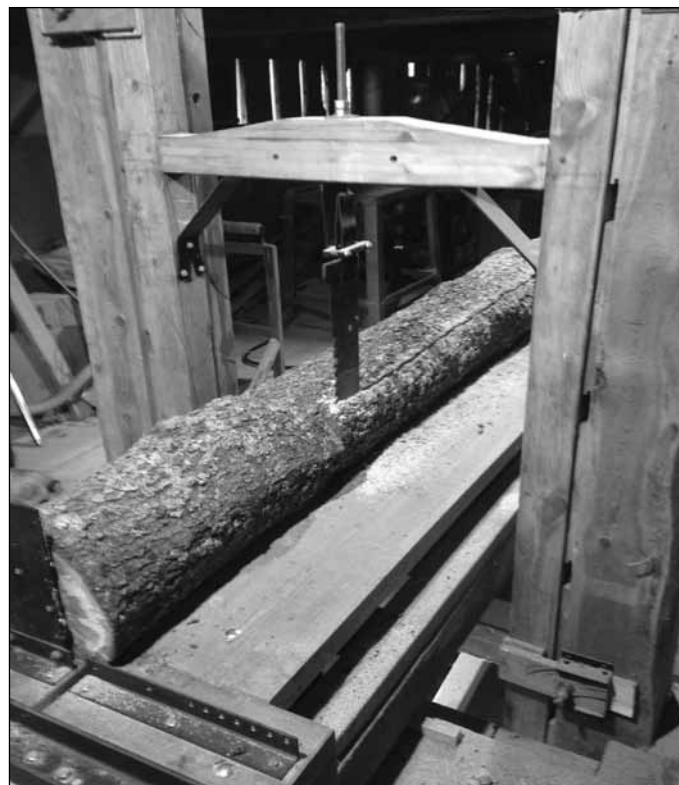
Bild 1. Kanske såg kronosågen vid Åkersån ut som denna gamla ramsåg där sågbladets upp- och nedåtgående rörelse drivs av ett vattenhjul. Foto: Sollentuna hembygdsförening.
