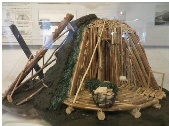
Modell av kolmila som visar hur milan är uppbyggd (lånad av Staffan Andersson, Björnlunda)
